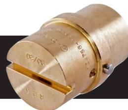
Die Rechteckdüse RE wurde für den Einsatz in Stranggussanlagen konzipiert und ist ausschliesslich für Kunden der Stahlherstellung vorgesehen. Das rechteckige Sprühbild deckt den Strang während der Kühlphase flächendeckend ab. Somit kann eine regelmässige Kühlung gewährleistet werden, welche ungleichmässige Spannungen innerhalb des Gefüges verhindert. Durch den gezielten Einsatz des Wassers, kann der Prozess ressourcenschonender gestaltet werden.
